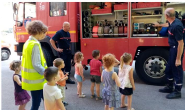
Le dos du camion, une fois le rideau arrière relevé, donne accès aux matériels (lances, tuyaux, raccords, divisions, émulseurs, appareils respiratoires isolants ...) et aux vannes de refoulement. La citerne, aussi appelée tonne, contient 2 000 litres d'eau. L'alimentation en eau de la tonne se fait par un poteau d'incendie, par un engin porteur d'eau ou par pompage dans un point d'eau naturel ou artificiel présent sur le lieu d'intervention (piscine, rivière, étang).
